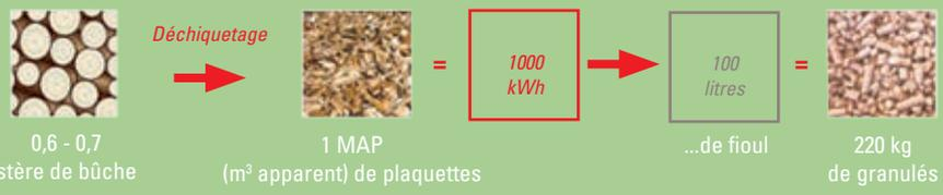
0,6 - 0,7 stère de bûche → Déchiquetage → 1 MAP (m<sup>3</sup> apparent) de plaquettes = 1000 kWh → 100 litres de fioul = 220 kg de granulés
